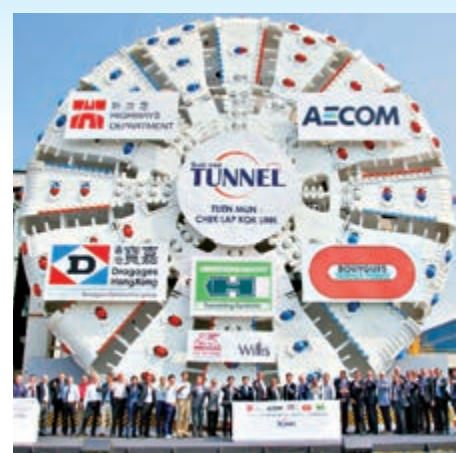
▲屯赤隧道引入目前世界上最大的隧道鑽挖機，直徑逾十七米，以明末名女將「秦良玉」命名
