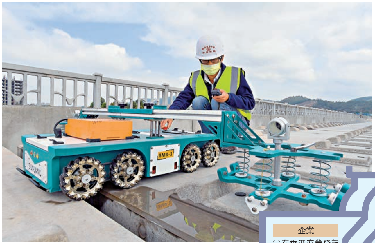
自二〇二一年一月一日起，香港工程建設企業和專業人士可在灣區內地九市開業執業。圖為工程師在高鐵軌道操作無砟軌道承載台檢測機器人對承載台進行檢測。資料圖片
