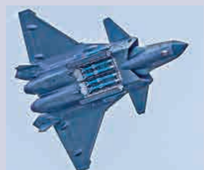
▲殲-20彈艙可裝載4枚中遠距空空導彈和2枚近距格鬥彈。
