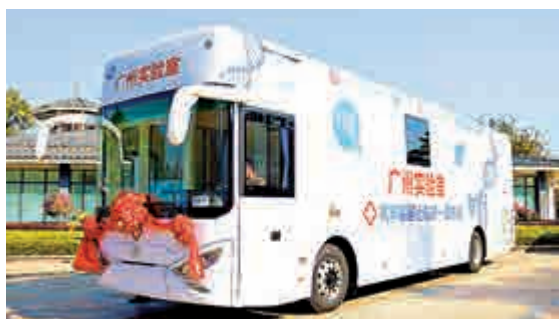
▲「獵鷹號」廣州實驗室移動採樣車是由大巴車改造而來。網絡圖片
