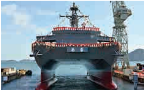
▲「安藝」號採取雙體船型，最大航速11節。網絡圖片
