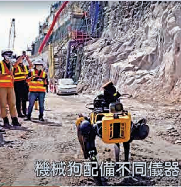
▲土力工程處通過特訓機械狗的活動能力，令它能深入工程人員難以到達的環境勘測。
