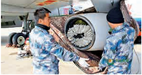
▲地勤官兵正在整備轟油-6的加油吊艙。
