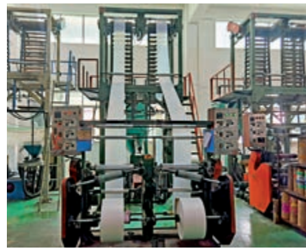
▲金藤公司廠房內機器正在加工可降解塑料袋。大公報記者郭若溪攝
