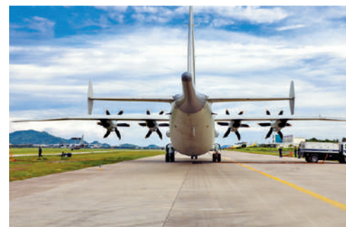
▲空潛-200尾部拖着長長的尾巴，即磁場異常探測儀，能夠通過探測地磁場的異常來判斷潛艇的存在。 網絡圖片
