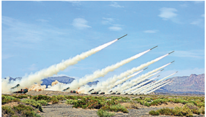
▲03式遠火是陸軍的主力遠程打擊裝備，整車有12根發射管。
