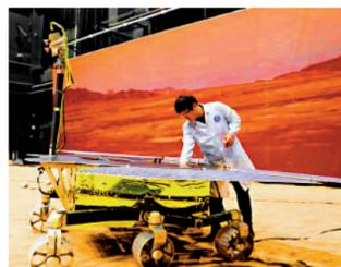
▲工作人員在航天五院內的火星模擬場地進行火星車移動試驗。
