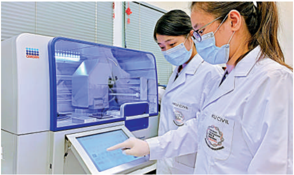
▲香港大學的團隊使用自動提取儀從污水中提取SARS-CoV-2的RNA。
