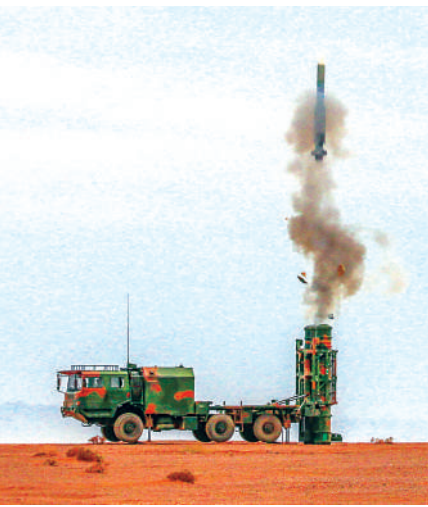
▲紅旗-16採用垂直冷發射，防空導彈拋射出筒後才在空中點火。
