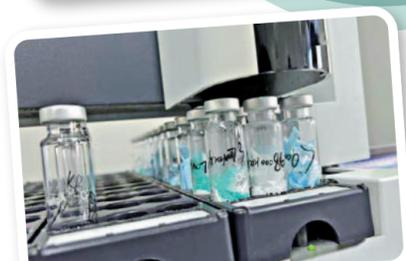
第二步 檢測人員將裝有口罩面料的定樣瓶放置於頂空進樣氣相色譜儀。
