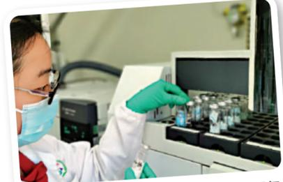
第三步 通過加熱使口罩面料中的環氧乙烷揮發，揮發出的氣體通過頂空進樣輸送至氣相色譜儀中。
