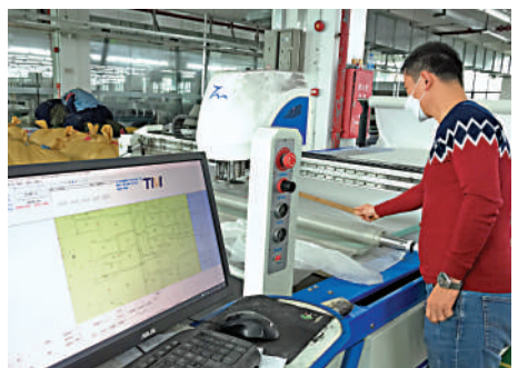
▲在數字化平台下，雲工廠內智能設備根據設計樣品，實現對服裝材料的精準裁剪。
