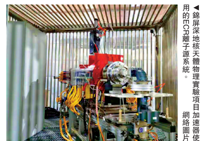
▲錦屏深地核天體物理實驗項目加速器使用的MCC離子源系統。 網絡圖片
