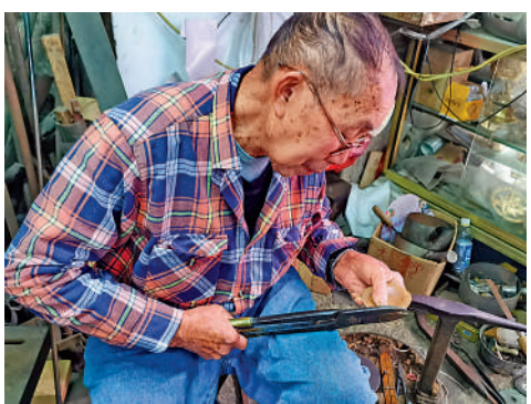
◀陸樹才先用鐵剪在銅塊上裁出合適尺寸。
