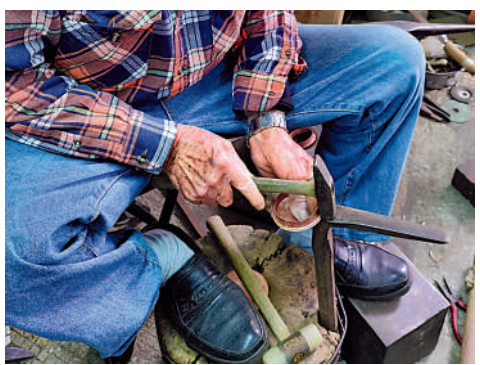
◀再經過多次反覆敲打，令壺蓋成型。
