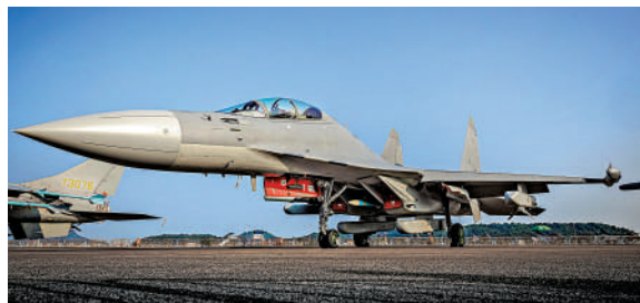
▲殲-16D能夠攜帶電子干擾吊艙弄盲敵方雷達，或直接發射反輻射導彈進行硬殺傷。
