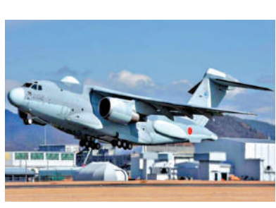
▲圖為以C-2運輸機為基礎改裝的RC-2電子偵察機。
