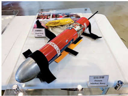
▲機組人員把「定位浮標」拋落目標海面，為飛機及拯救人員定位。
