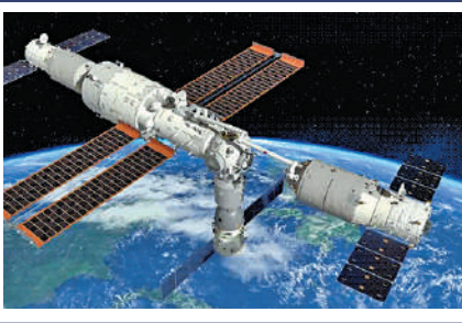
▲2022年1月6日6時59分，經過約47分鐘協同，空間站機械臂轉位貨運飛船試驗圓滿成功。
