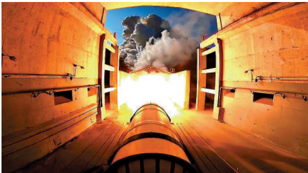
▲2020年12月，可滿足載人登月需求的大型固體火箭助推發動機在西安完成首次地面試車。
