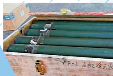
▲為重慶人工增雨準備的飛機冷雲火焰條。
