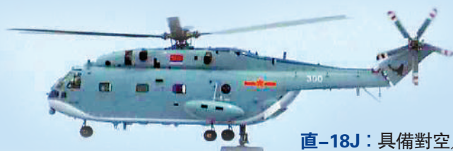
直-18J：具備對空／對海搜索、警戒跟蹤、目標引導等能力，機載警戒雷達的可靠性得到了極大的提高，抗干擾能力強。
