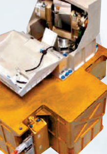
▶嫦娥五號著陸器配置的「月球礦物光譜儀」。網絡圖片
