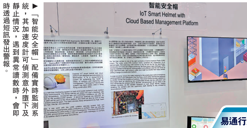
「智能安全帽」配備實時監測系統，其加速度計可偵測意外墮下及靜止情況，遇到異常讀數時，會即時透過短訊發出警報。
