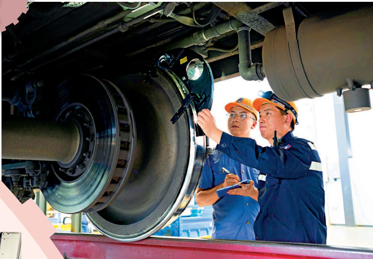
▲工作人員利用輪徑尺測量動車組車輪輪徑，保證各項數據合格。
