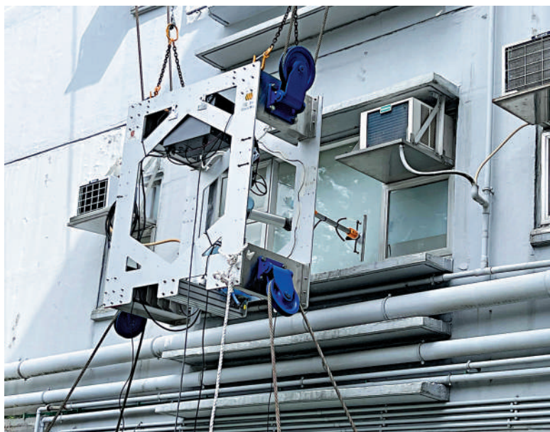
▲多條纜索可控制內置機械臂的平台在空中順暢移動，比一般吊船更穩定。 大公報記者鍾怡攝
