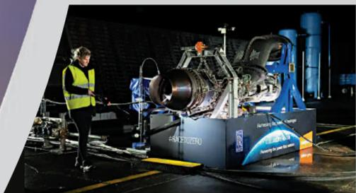
▲勞斯萊斯氫燃料航空引擎試驗所使用的發動機。網絡圖片
