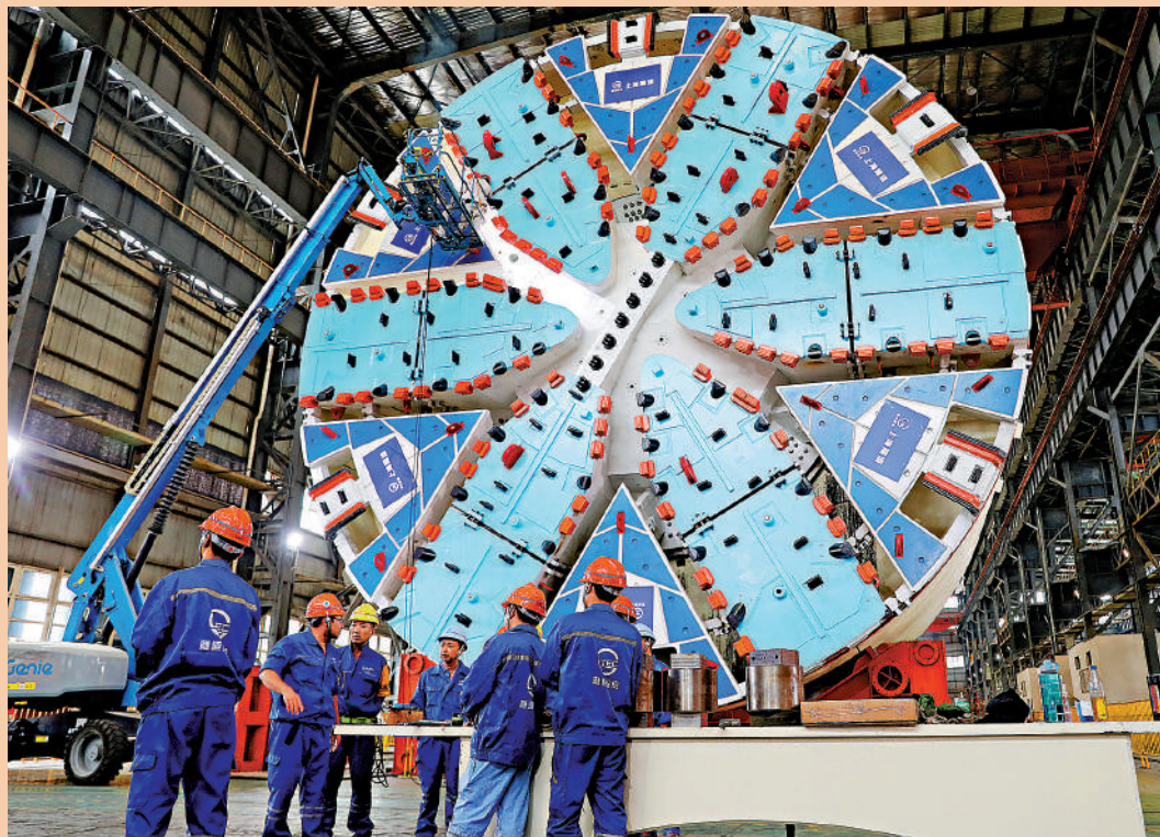
▲中國科研團隊開發出「低氧稀土鋼」關鍵技術，採用這一技術生產的稀土軸承鋼性能好於進口產品。圖為上海自主研製的超大直徑盾構機「騏驎號」在進行安裝調試。 新華社
