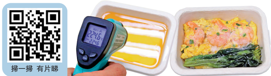
▲陳大仁測試新式環保餐盒裝水、裝油，發現即使在200多度的高溫和濕度高的環境下，餐盒亦未變形。
