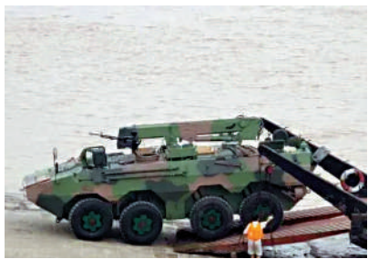
▲「大八輪」裝甲搶修車配備起重吊臂，協助更換戰車損壞的部件。
