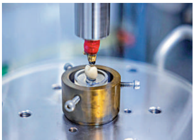
▲新型纖維增強複合樹脂材料製成的人牙替代材料，應用在牙冠疲勞測試。
