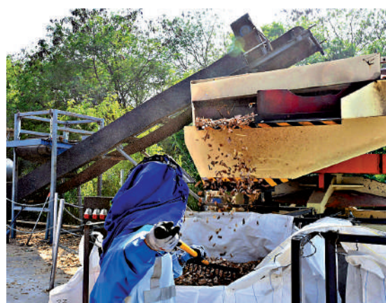
▲〔林·區〕設有木材破碎機等設備，能將合適的園林廢物，轉化成有用物料。
