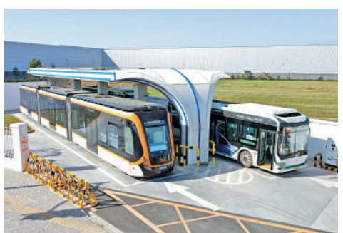
▲臨港新城的一輛氫能公交車駛入氫能公交站加氣站加氣。
