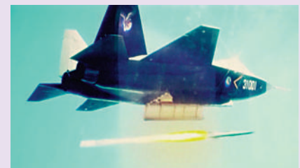
▲圖為中航飛發發布的「鸞鷹」發射機腹導彈畫面。殲-35料可以相近形式發射霹靂-15。
