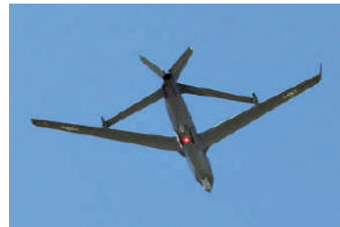
▲無偵-7採用菱形連接翼氣動布局，降低飛行阻力。
