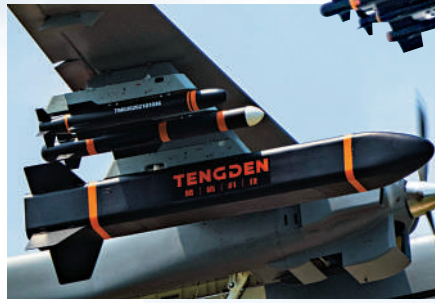
▲「雙尾蠍A」兩翼各有三個掛架，每掛架可視需要安裝複合掛點增加掛彈量，也可掛載單枚重型彈藥如精確制導布撒器。
