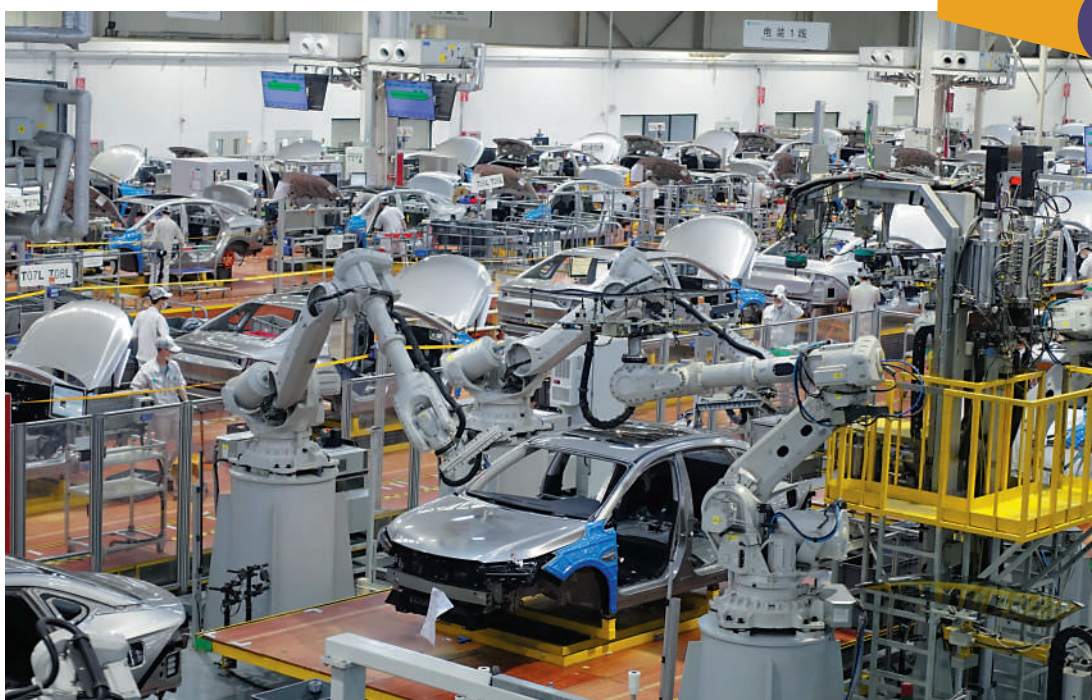
▲廣汽埃安智能化車間的機器人能自動識別車型，自動裝配玻璃。 大公報記者盧靜怡攝
