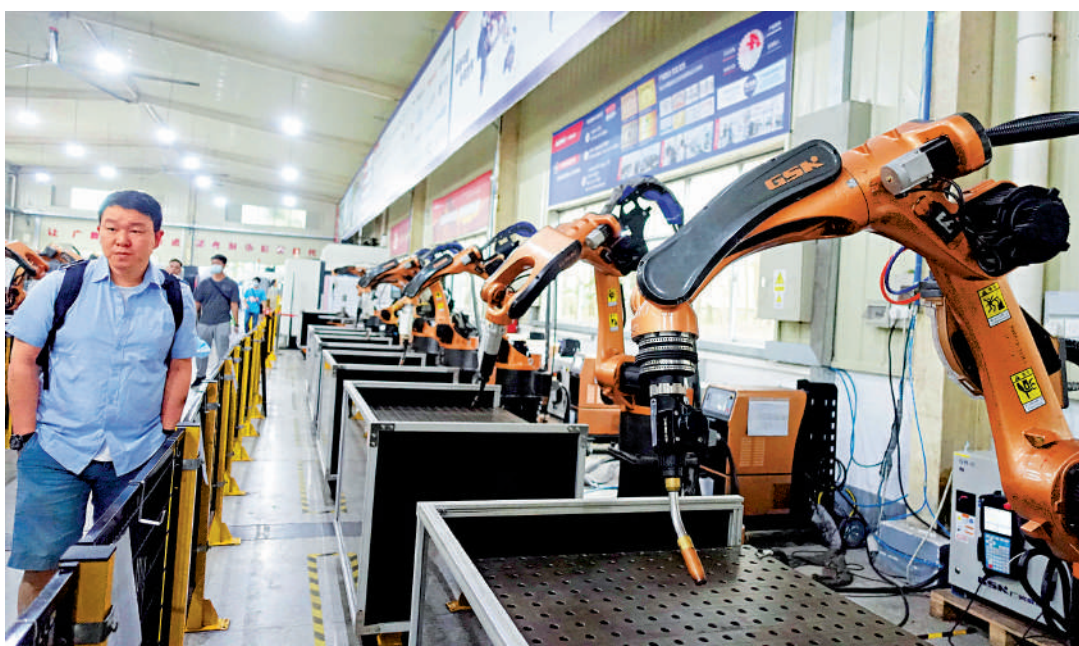
▲廣州數控自主研發的焊接機械臂數控「神焊」焊接精度可達到0.05毫米。大公報記者盧靜怡攝
