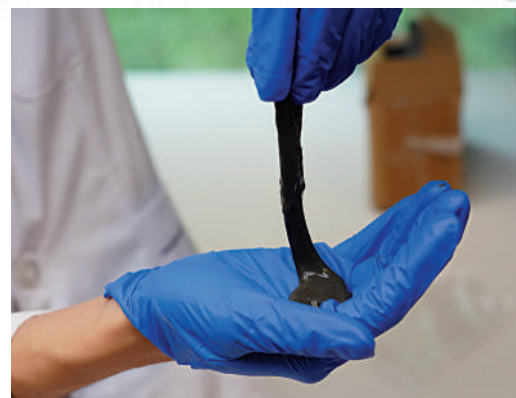
▲「史萊姆」機械人主要以水凝膠和磁性顆粒「鈹鐵硼」製成，可自由轉變成不同形狀。 大公報記者林良堅攝
