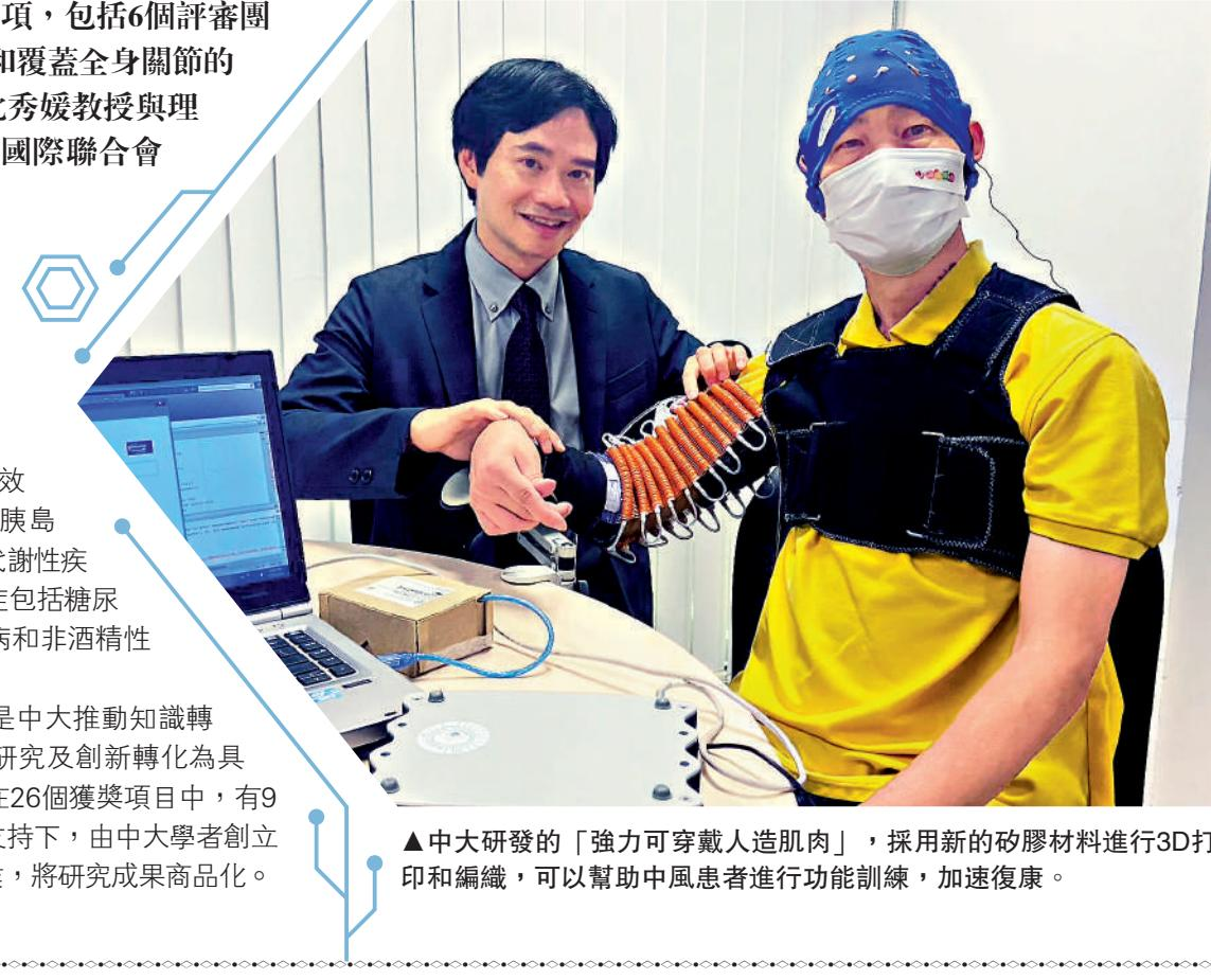
▲中大研發的「強力可穿戴人造肌肉」，採用新的矽膠材料進行3D打印和編織，可以幫助中風患者進行功能訓練，加速復康。
