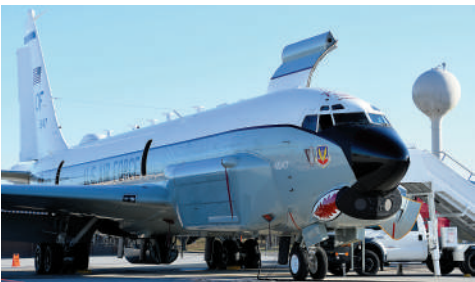
RC-135U電子偵察機機頭安裝了特有的電子偵察設備。
