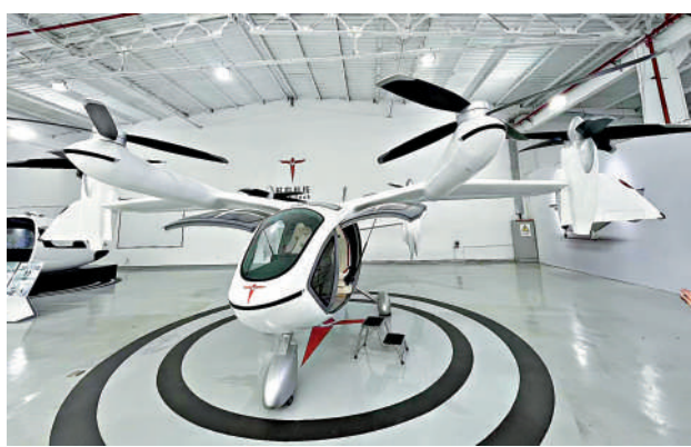
▲機型代號為「E20」的全尺寸工程驗證機。
