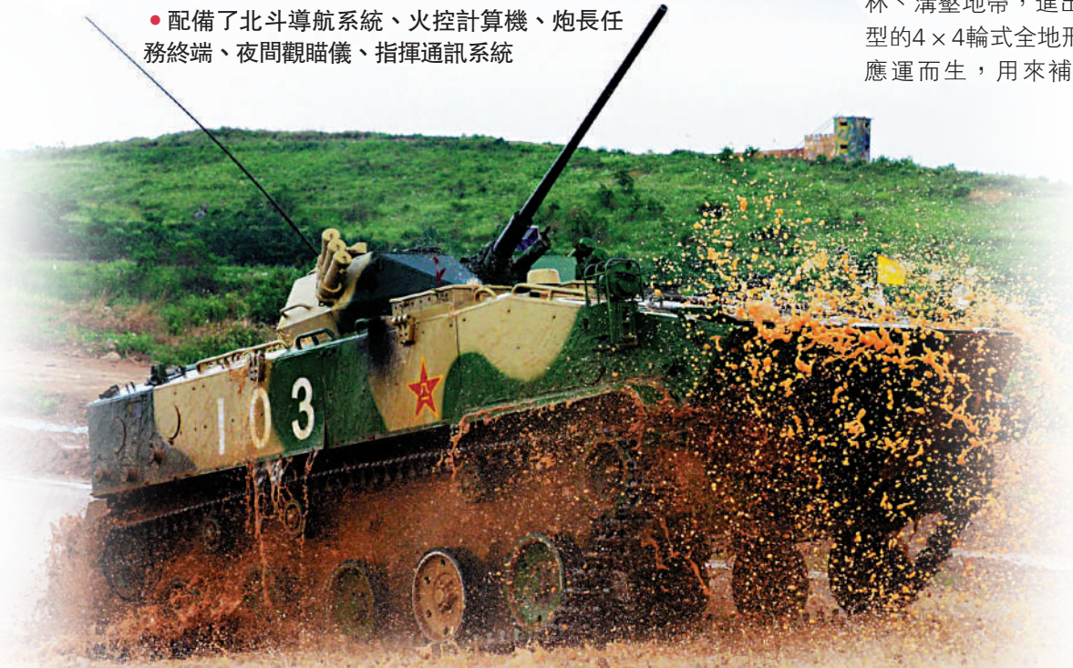
▲新型自行迫榴炮採用ZBD-03的底盤，但30毫米機關炮換成120毫米自行迫榴炮。圖為ZBD-03空降步兵戰車。
