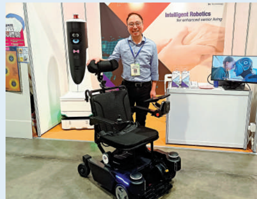
▲有機構設計研發「智遊椅」，為電動輪椅加入導航系統及雷達避障功能，可直接設定路線。大公報記者王亞毛攝
