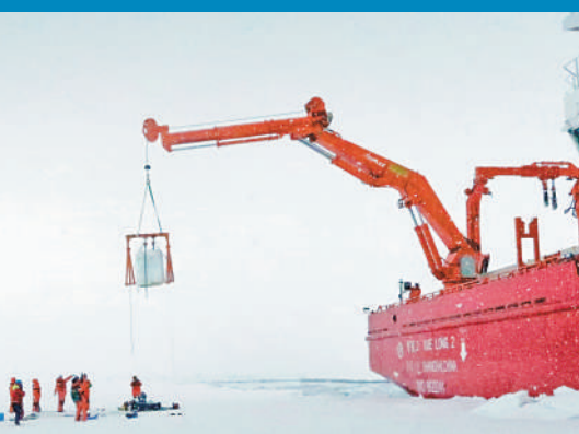
石島工業建造的「雪龍2號」運輸吊機可在極地低溫環境下工作。受訪者供圖
