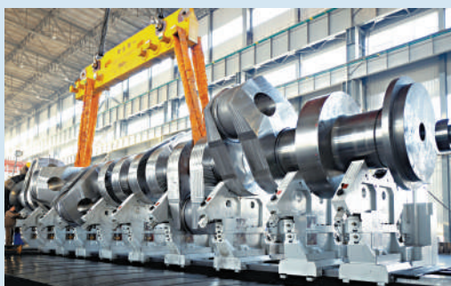
大連華銳重工車間內待檢加工的大型船用曲軸。受訪者供圖
