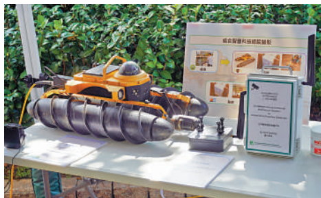
▲管網檢測機械人「聲探」協助檢查，工程人員可減少進入管道工作。大公報記者林少權攝
