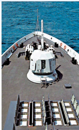
▲中國054A護衛艦如驅逐艦般裝設垂直發射系統。
