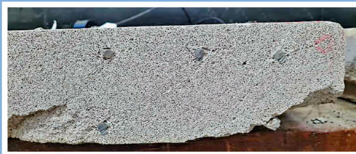
▲RAAC材料內部含有大量氣泡，該材料隨着時間推移會令建築存在坍塌風險。 網絡圖片
