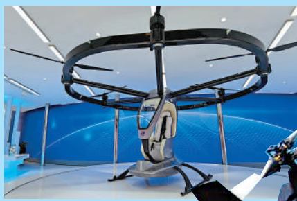
▲航空工業展出AR300全電驅動六旋翼飛行器。
